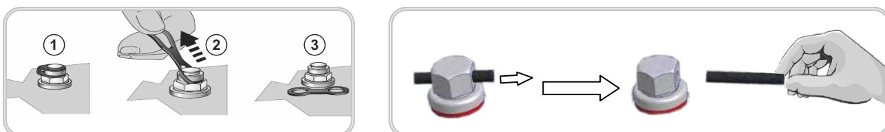
1. Защищенная вентиляционная пробка для транспортировки,
