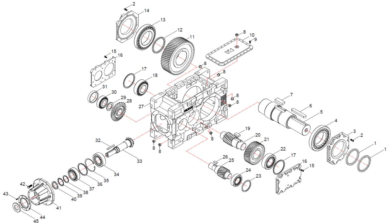
Принципиальная схема деталей стандартного типа ВТ...3.01. При использовании по специальному назначению детали могут отличаться.
