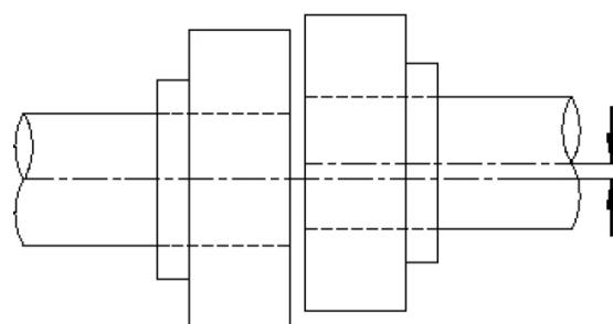
6.6.3 При установке муфт убедитесь, что между двумя валами отсутствует угловое отклонение.
