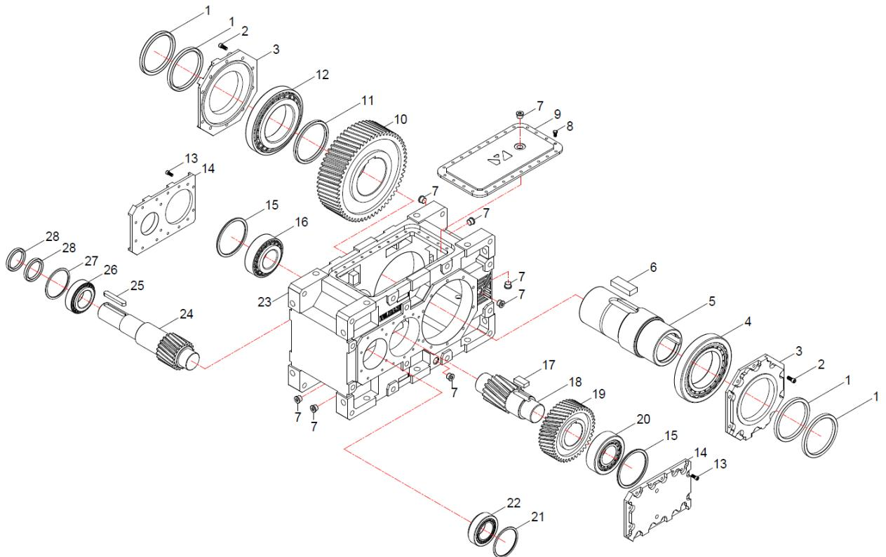
**Принципиальная схема деталей стандартного типа НТ...2.00. При использовании по специальному назначению детали могут отличаться.**
