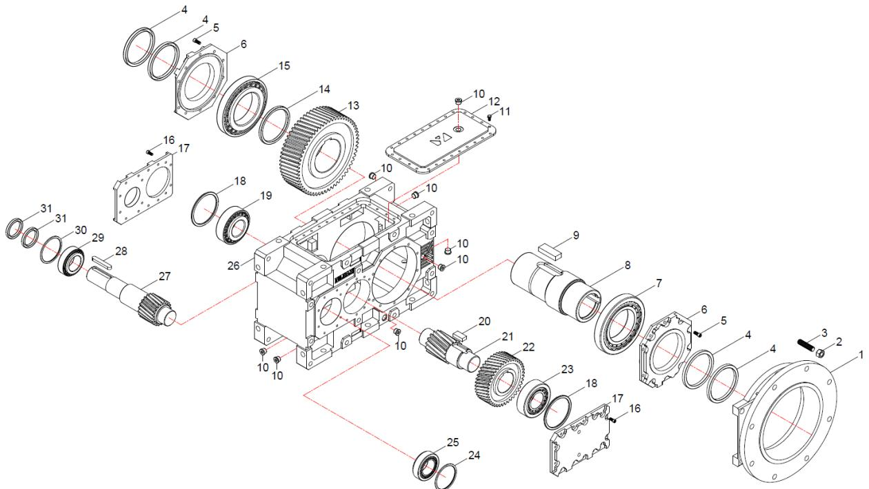
*Принципиальная схема деталей стандартного типа НТ...2.03. При использовании по специальному назначению детали могут отличаться.*
