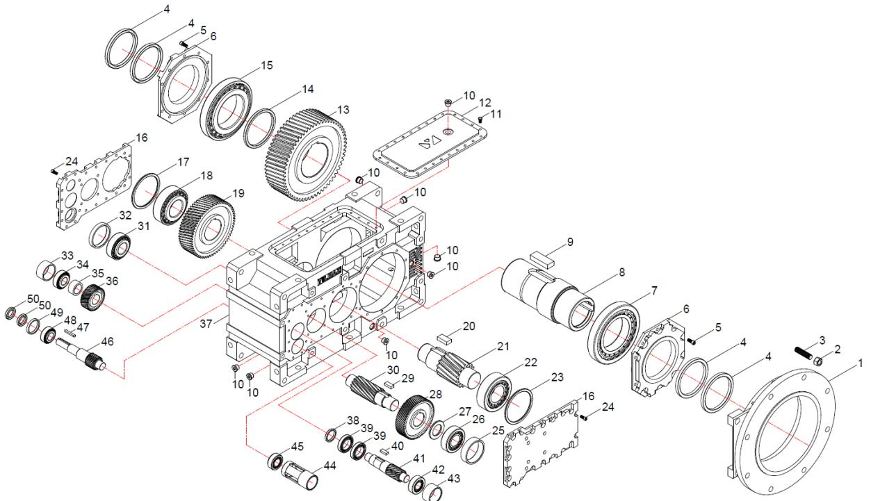
**Принципиальная схема деталей стандартного типа НТ...4.03. При использовании по специальному назначению детали могут отличаться.**
