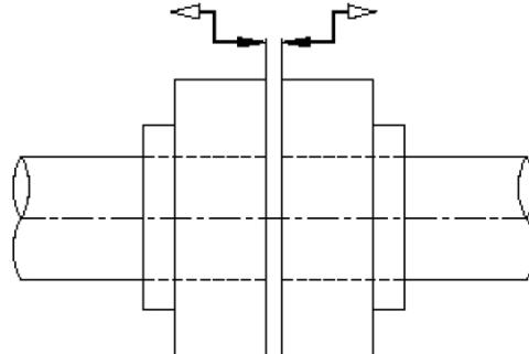
6.6.2 При установке муфт убедитесь, что между двумя валами отсутствует эксцентричность.
