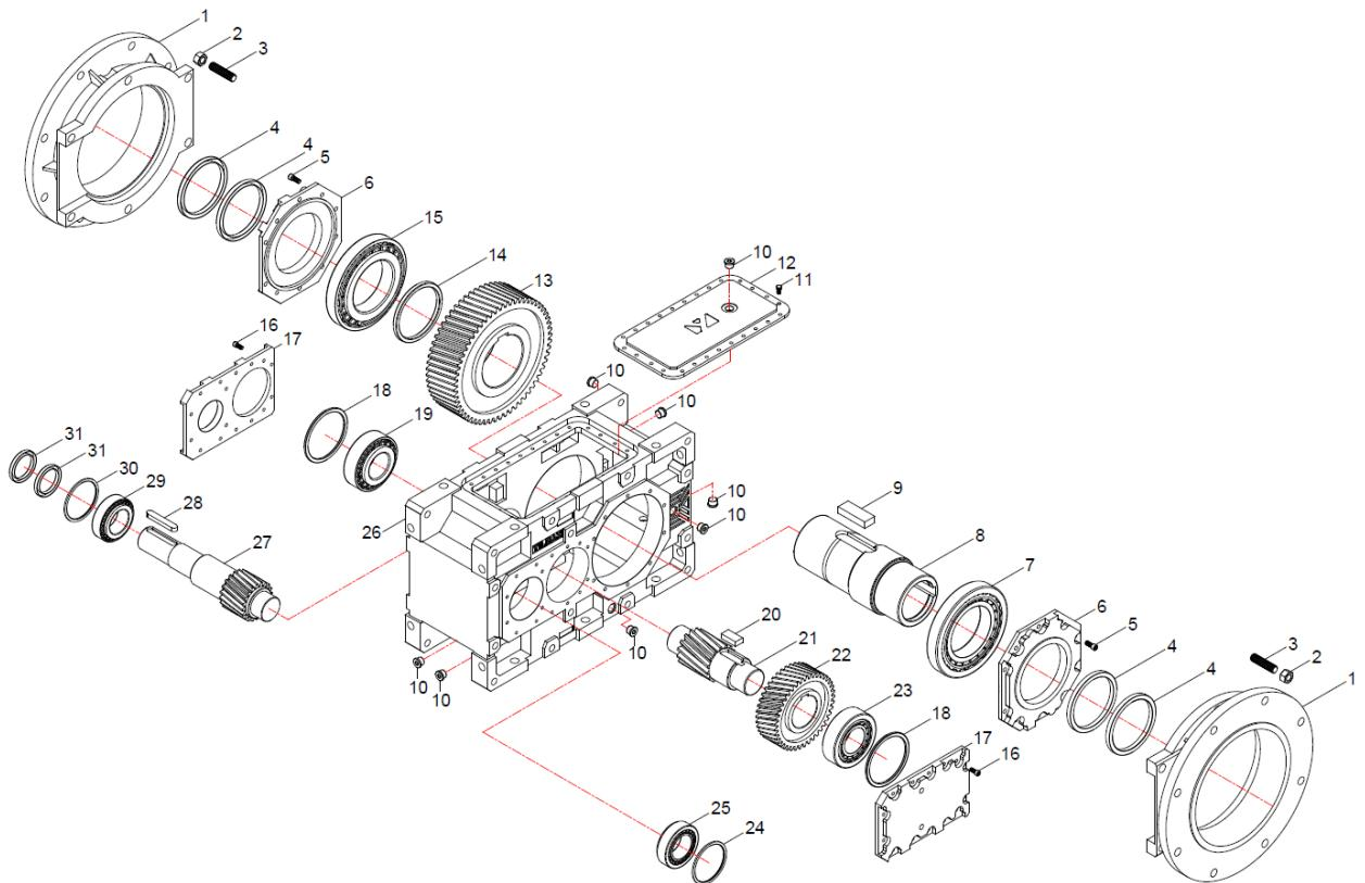
**Принципиальная схема деталей стандартного типа НТ...2.08. При использовании по специальному назначению детали могут отличаться.**
