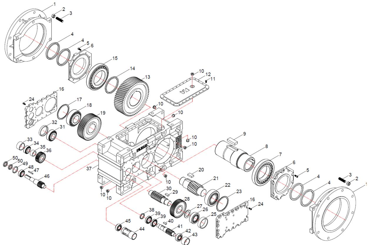
Принципиальная схема деталей стандартного типа НТ...4.08. При использовании по специальному назначению детали могут отличаться.
