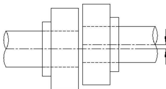
6.6.3 При установке муфт убедитесь, что между двумя валами отсутствует угловое отклонение.
