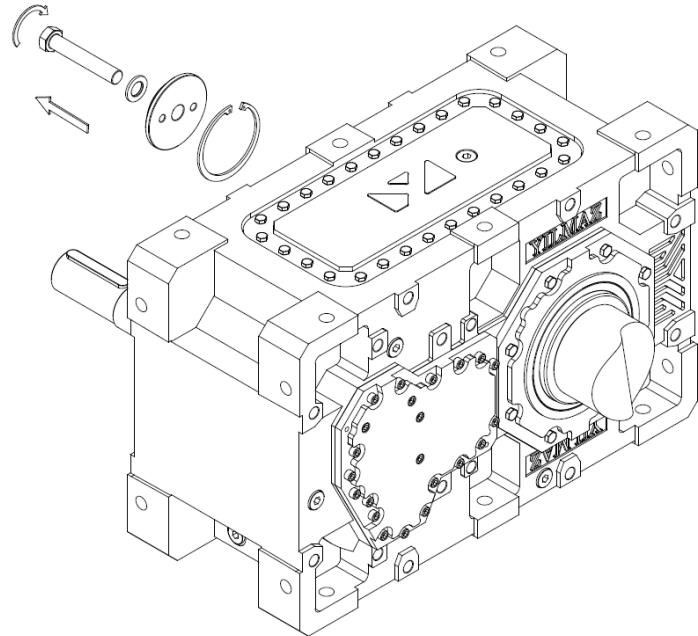
6.3.2 Используйте набор для демонтажа, поставляемый компанией YILMAZ, и затяните болты в следующем порядке, чтобы извлечь выходной вал.
