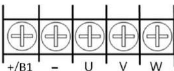
Момент затяжки винтов на силовых клеммах преобразователя 1,4 Н•м.
