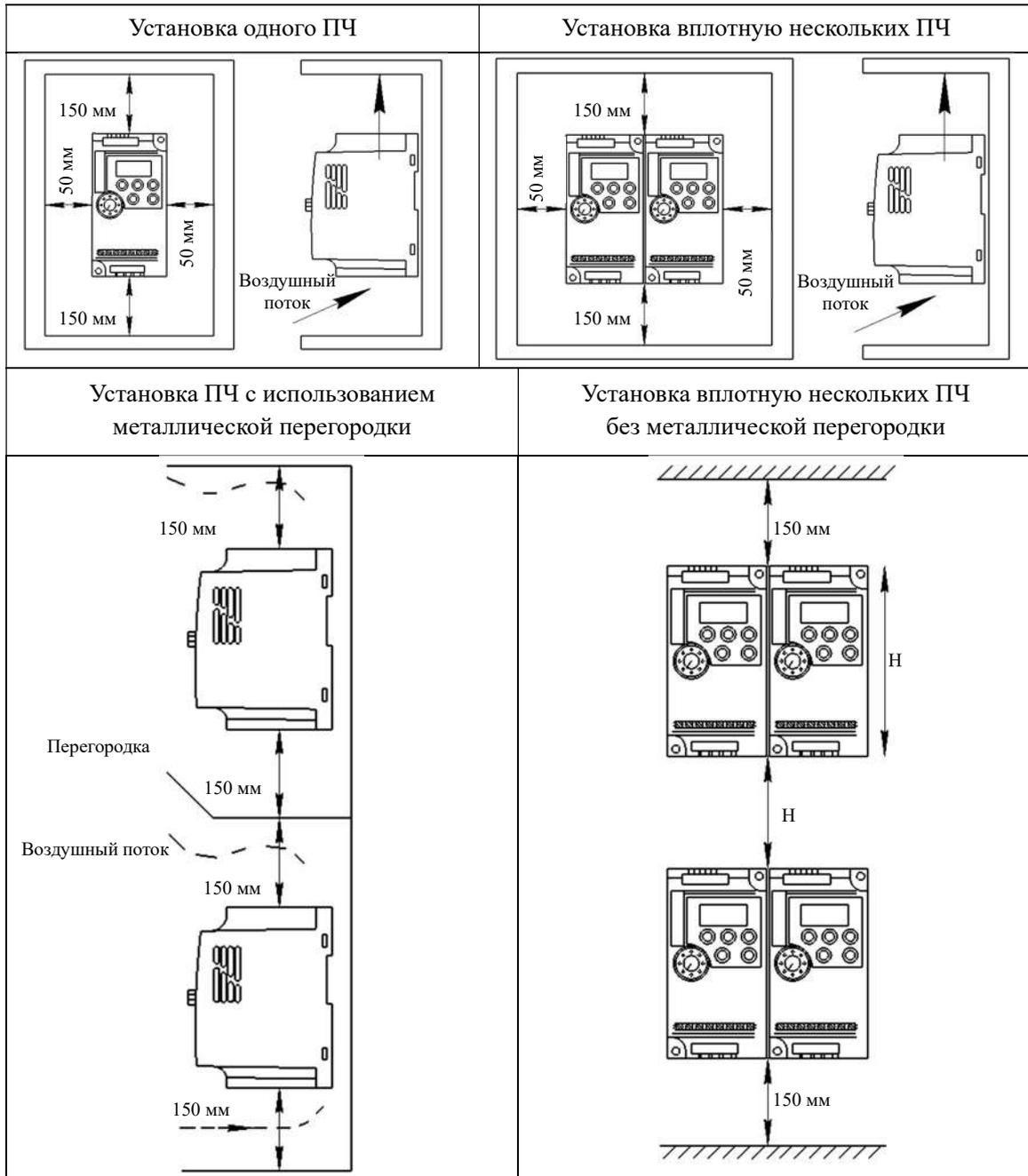
Перед монтажом нескольких ПЧ в один шкаф управления убедитесь, что в нем достаточно свободного пространства, имеется хороший теплообмен (температура внутри шкафа не должна превышать  $+40^{\circ}\text{C}$ ). Если ПЧ установлены рядом друг с другом, то расстояние между преобразователями должно быть больше 50 мм (разрешается устанавливать ПЧ мощностью до 11 кВт включительно вплотную.)
