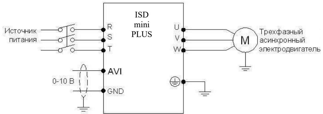
Аналоговое напряжение 0-10В можно сформировать внешним потенциометром 10кОм. Изменение частоты происходит при изменении напряжения от 0 до 10 В между клеммами AVI и GND:
