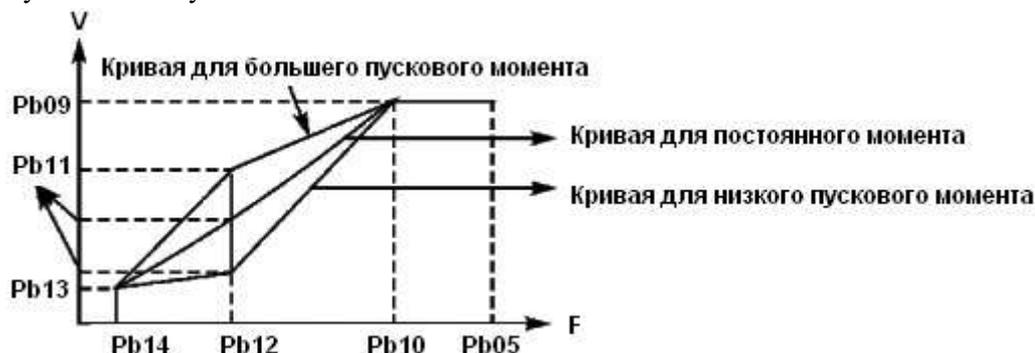
Форма V/F-кривой ПЧ задается с помощью группы параметров Pb09- Pb14. Различной нагрузке соответствуют различные V/F-кривые.
