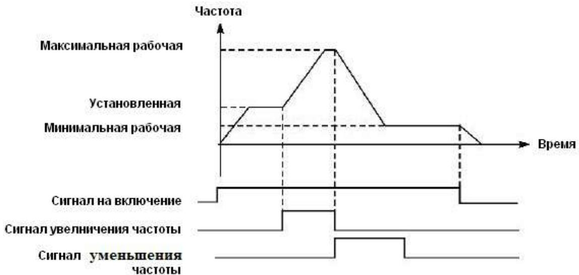
Внимание: по умолчанию заданная частота, установленная с помощью команд «UP» и «DOWN» не будет сохранена в памяти после выключения ПЧ, и при последующем запуске частота будет установлена в соответствии со значением параметра P<sub>b00</sub>. (См. также P<sub>i12</sub>)
