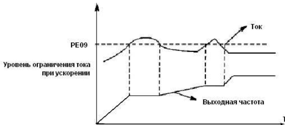
Величина тока перегрузки 100% соответствует номинальному току ПЧ (т.е. предельно возможной величине параметра PC10 в диапазоне допустимых значений). Защита отключена при PE09=0.
