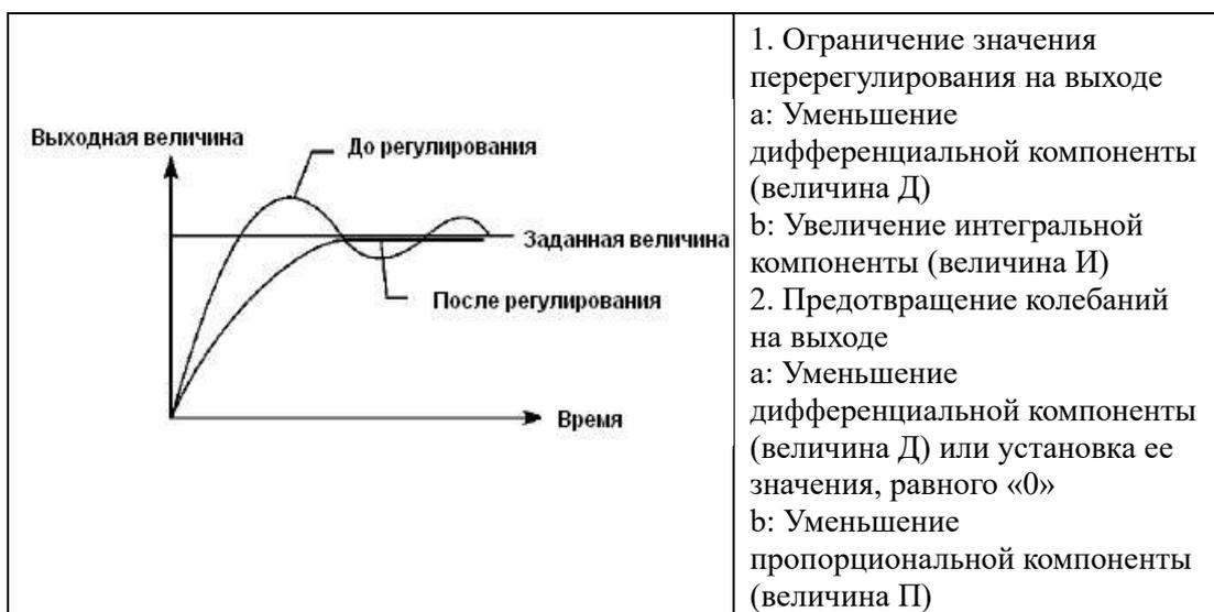
При использовании только П – закона регулирования возможна установившаяся ошибка регулирования с величиной до  $\pm 10\%$  от значения максимального сигнала обратной связи.
