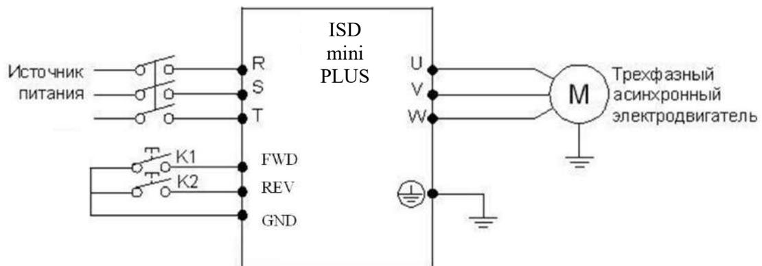
Пример работы преобразователя: Pb02=1, Pd15=6, Pd16=7, Pd29=0
