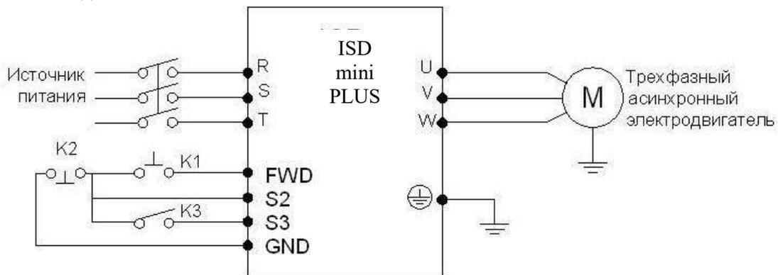
(2) Настройка параметра PF33 определяющего направления вращения
