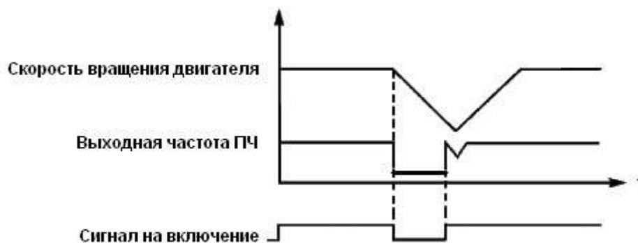
**Внимание:** во время запуска с поиском частоты ПЧ начинает поиск частоты с верхней границы до нижней границы частоты. Это может привести к возникновению перегрузки по току, поэтому необходимо правильно выбрать уровень перегрузки по току (параметр PE09) в зависимости от нагрузки.
