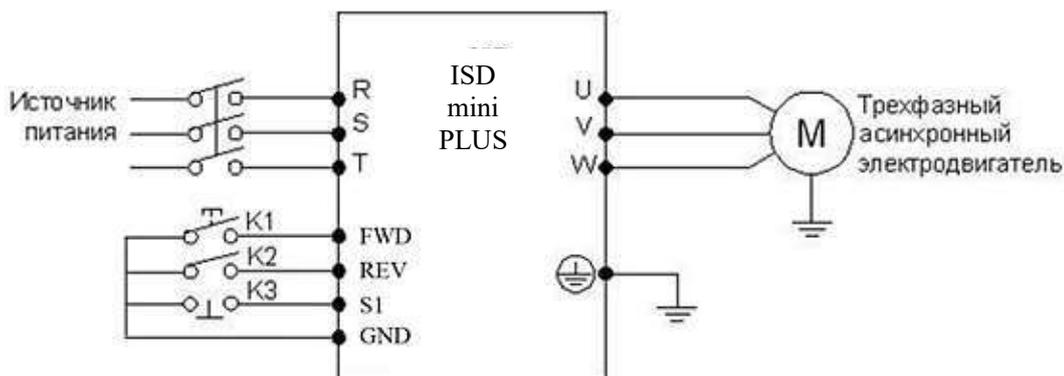
Пример работы преобразователя: P<sub>b02</sub>=1, P<sub>d15</sub>=6, P<sub>d16</sub>=7, P<sub>d17</sub>=8, P<sub>d29</sub>=3
