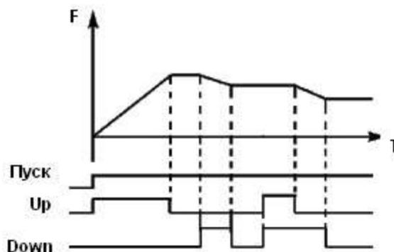
Пояснение: когда действует функция UP (соответствующий контакт замкнут), происходит увеличение частоты. Когда действует функция DOWN, (соответствующий контакт замкнут), происходит уменьшение частоты
