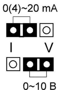
Аналоговые выходы FOC и FIV являются универсальными и поддерживают сигналы (0-10В / 0(4)-20мА). Для выбора режима работы выхода FOC используется переключатель J4. Для выбора режима работы выхода FOV используется переключатель J8.
