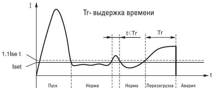
Рис. 5 - Диаграмма работы реле при перегрузке
