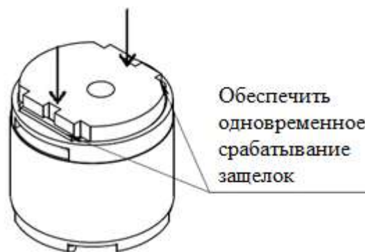
Рисунок 3.13 – Схема установки КИ в ФИД
