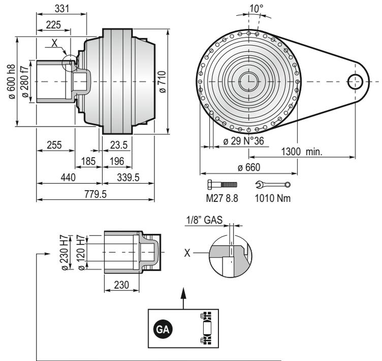
Das dargestellte, maximale Drehmoment gilt nur mit von Planetary Drives gelieferter Schrumpfscheibe
