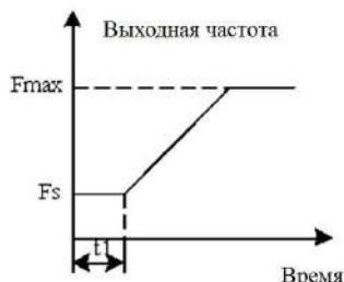
Рис.6-3 Пусковая частота и время выдержки пусковой частоты
