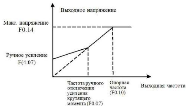
Рис.6-10 Схема усиления крутящего момента
