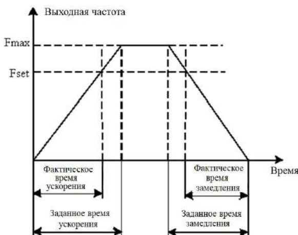
Рис. 6-2 Схема времени ускорения/замедления
