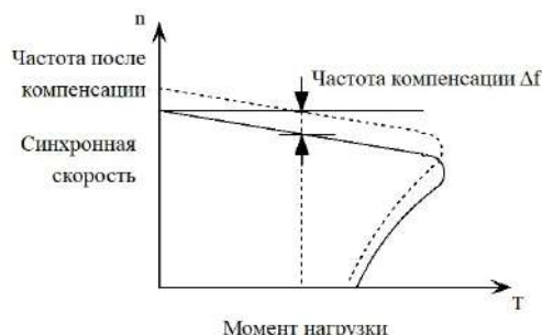
Рис. 6-11 Автоматическая компенсация скольжения
