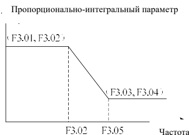
Рис. 6-7 Схема пропорционально-интегральных параметров контура скорости
