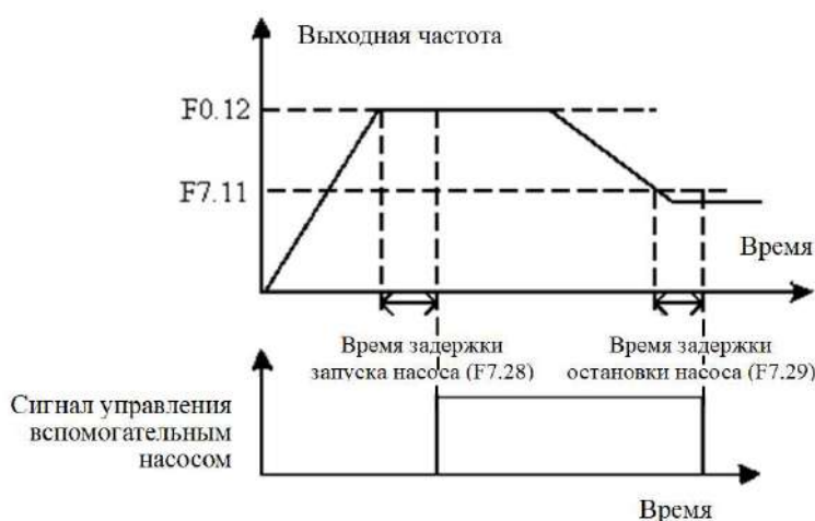
Рис. 6-22 Сигнал управления вспомогательным насосом для постоянной подачи воды под давлением
