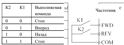
Рис.6-13 Двухпроводной режим управления 1
