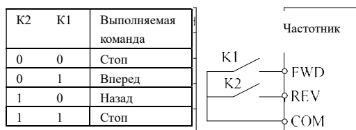
Рис.6-13 Двухпроводной режим управления 1
