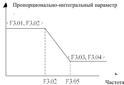
Рис. 6-7 Схема пропорционально-интегральных параметров контура скорости
