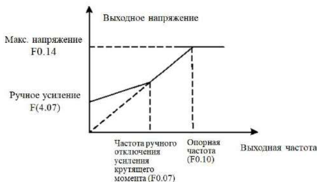
Рис.6-10 Схема усиления крутящего момента
