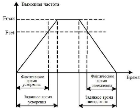
Рис. 6-2 Схема времени ускорения/замедления
