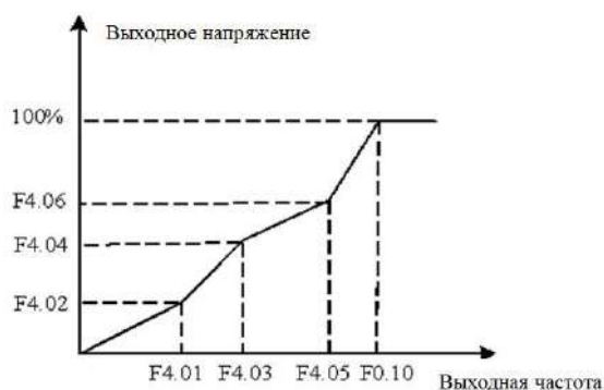
Рис.6-9 Кривая зависимости напряжения от частоты, определяемая пользователем
