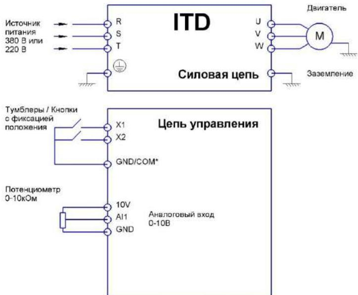
GND/COM\* – (GND – для моделей до 4 кВт включительно, COM – от 5,5 кВт и выше)
