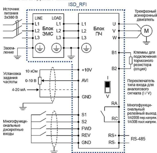
Преобразователь частоты ISD\_RFI состоит из блока ЭМС и блока ПЧ, соединяемых между собой при помощи комплектного силового кабеля.
