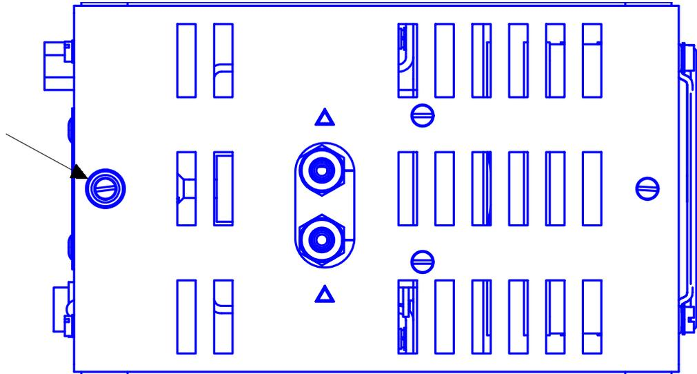
Примечание - Стрелкой указано место пломбировки от несанкционированного доступа и обозначение места для нанесения оттиска клейма.
