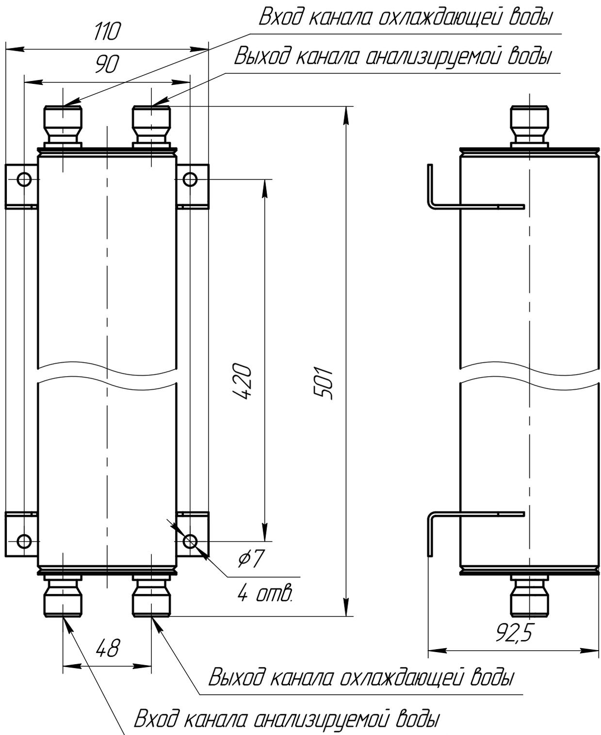
Рисунок 1 – Холодильник водяной ХК-4. Габаритные, установочные и присоединительные размеры
