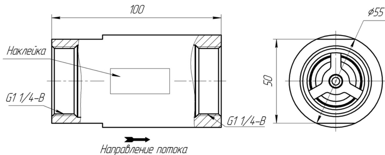
Рисунок 1 – Клапан термозапорный типа DN 32.
