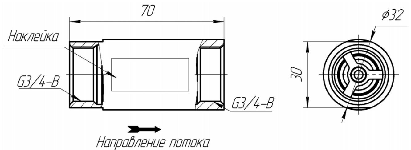
Рисунок 1 – Клапан термозапорный типа DN 20.
