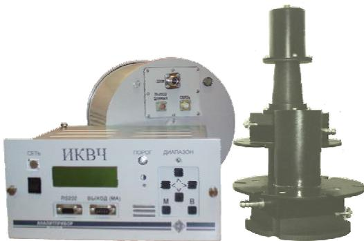
**Предназначен** для непрерывного измерения оптической плотности пылегазовых сред и пульсаций, оптической плотности дымовых потоков, а также массовых концентраций взвешенных частиц (пыли) (МКП) через пересчетную функцию.
