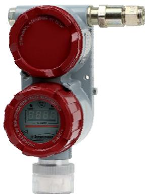
Датчики-газоанализаторы предназначены для непрерывного автоматического измерения дозрывоопасных концентраций метана ( $\text{CH}_4$ ), углеводородов, в том числе паров нефти и нефтепродуктов, попутного нефтяного газа, спиртов, а также объемной доли диоксида углерода ( $\text{CO}_2$ ).
