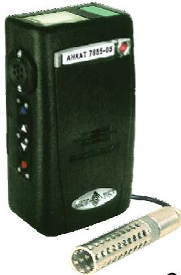
**Предназначены** для автоматического непрерывного измерения концентрации растворенного кислорода и температуры (только АНККАТ7655-05).
