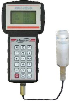
**Предназначены** для автоматического измерения массовой концентрации растворенного кислорода и температуры в водной среде для контроля водно-химического режима котлоагрегатов на предприятиях электро- и теплоэнергетики и других отраслей промышленности.
