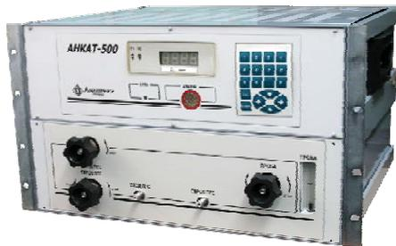
**Предназначен** для непрерывного измерения объемной доли микроконцентраций кислорода в различных газах (азоте, аргоне, гелии, водороде, пропилене и др.).
