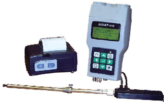
**Предназначен** для проведения пуско-наладочных работ при эксплуатации топливосжигающих установок с целью оптимизации режимов горения, а также контроля экологически вредных выбросов. Измеряет и вычисляет компонентный состав, температуру и другие параметры дымовых газов при контроле режимов горения различных видов топлива (газ, уголь, мазут) в котельных установках малой и средней мощности (котлы, турбины, горелки и т.д.).
