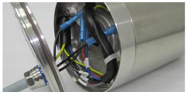
Размер клеммной коробки соответствует габариту корпуса двигателя, что облегчает электромонтаж
