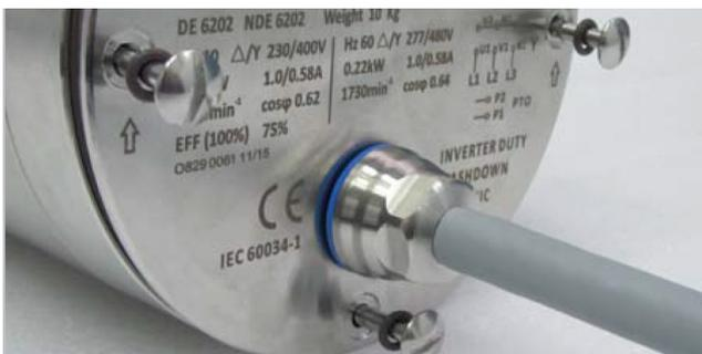
Класс защиты корпуса IP69K. Все части двигателя, включая винты, соединяются через уплотнительные кольца из вайтона
