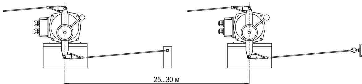
Трос диаметром 5 мм продевается в проушины и закрепляется зажимами. При длине троса более 15 метров следует устанавливать поддерживающие опоры через каждые 3 метра, а при длине троса в 25 метров – через каждый метр. Монтажное основание изготавливается заказчиком самостоятельно. Трос и зажимы в комплект поставки не входят.
