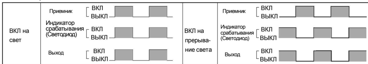
\* Для предотвращения некорректного срабатывания фотодатчика, выход остается закрытым в течение 0.5 сек после подачи питания (диффузионный датчик, датчик с отражателем).
